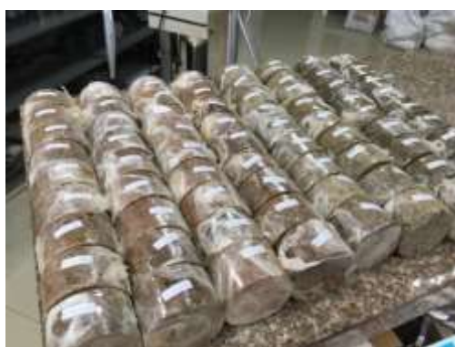
รูปที่ 5 แสดงการเตรียมก้อนตัวอย่างเพื่อนำมาทดสอบคุณสมบัติเชิงวิศวกรรมในห้องปฏิบัติการ
