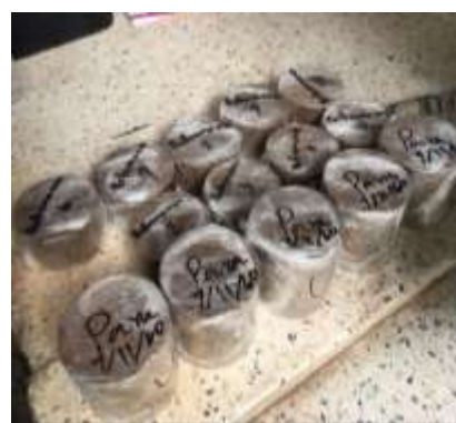
รูปที่ 5 แสดงการเตรียมก้อนตัวอย่างเพื่อนำมาทดสอบคุณสมบัติเชิงวิศวกรรมในห้องปฏิบัติการ
